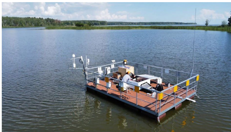
Рис.1. Плавучая платформа с оборудованием для оценки потоков парниковых газов методом турбулентных пульсаций в акватории Куйбышевского водохранилища ( https://kpfu.ru/ecology/karbon-povolzhe , фото: В.Е. Прохоров).
